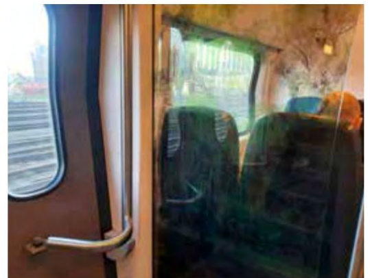
Train VIRM : ces sièges fixes sur le portique peuvent être remplacés par des strapontins et trois crochets pour vélos.
